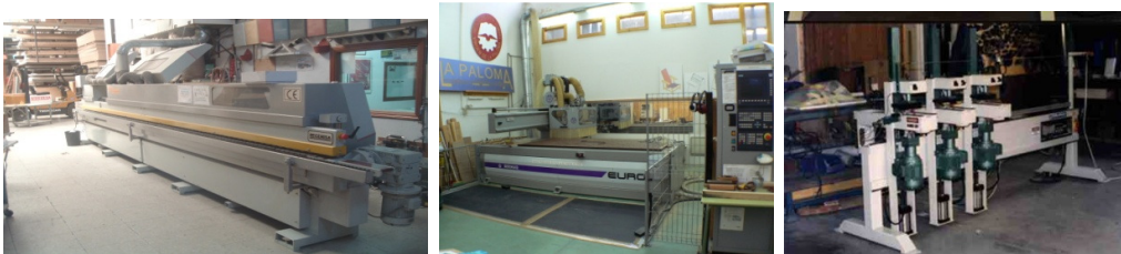
Figura 2.27. Maquinaria automática de trabajo en construcción de cocinas.
